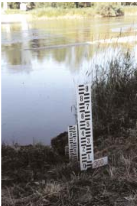
Mjerenje vodostaja - vodokazna letva, Goričan, DHMZ
