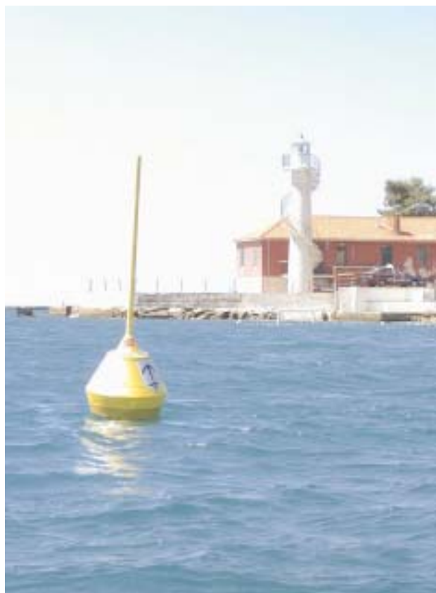
Plutača za mjerenje temperature mora, Umag, DHMZ
