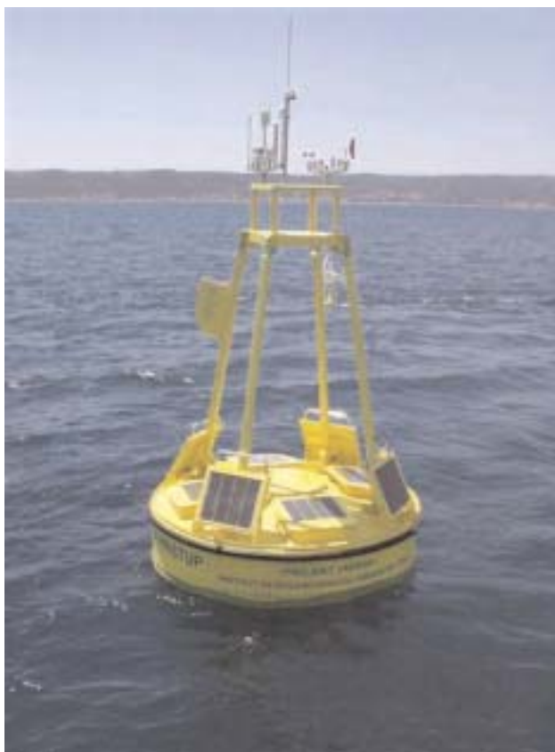
Fiksna automatska oceanografska meteorološka postaja na usidrenoj plutači, Srednji Jadran, IOR, Split
